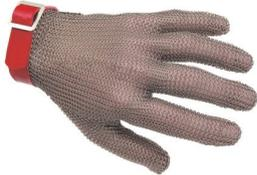
Gant universel cote de mailles en acier inoxydable avec sangle plastique amovible. Fermeture par sangle plastique avec bouton pression et boucle réglable. Version réversible ambidextre. Pour travaux avec couteaux et autres objets coupants ou perforants. Adapté pour la découpe manuelle. Déconseillé pour le travail en machine, type découpeuse, éplucheuse,... EPI catégorie 2 (Directive 89/686/CEE) - EN 1082-1 - ISO 13999-1.
