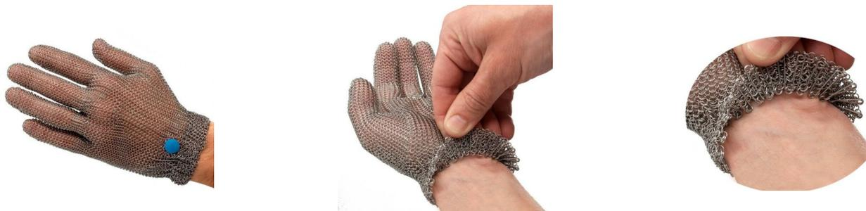
Gant cotte de maille 100% acier inoxydable. Zone de protection : main. Fermeture par ressort inox auto réglable. Version réversible ambidextre (en le retournant sur lui même). Travaux avec couteaux et autres objets coupants ou perforants. EPI Catégorie 2 (Directive européenne 89/686/CEE) Normes EN1082-1 - ISO13999-1
